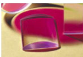
плосковыпуклые и плосковогнутые, стандартные – ошибка фокусного расстояния  $f \pm 2\%$  и прецизионные  $f \pm 0.5\%$ ,  $\Delta N=(0.5-1)$ ; без покрытия и просветленные на длины волн от 193нм до 2100нм, материал: стекло и УФ кварцевое стекло (лучевая стойкость 10 Дж/см<sup>2</sup>, 20 нс, 20Гц,  $\lambda=1064$  nm), а также УФ CaF2 (лучевая стойкость 1 Дж/см<sup>2</sup>, 20 нс, 20Гц,  $\lambda=1064$  nm),
