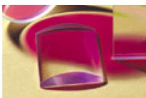
плосковыпуклые и плосковогнутые, стандартные – ошибка фокусного расстояния  $f \pm 2\%$  и прецизионные  $f \pm 0.5\%$ ,  $\Delta N=(0.5-1)$ ; без покрытия и просветленные на длины волн от 193нм до 2100нм, материал: стекло и УФ кварцевое стекло (лучевая стойкость 10 Дж/см<sup>2</sup>, 20 нс, 20Гц,  $\lambda=1064$  nm), а также УФ CaF<sub>2</sub> (лучевая стойкость 1 Дж/см<sup>2</sup>, 20 нс, 20Гц,  $\lambda=1064$  nm),
